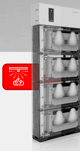
Modulonkénti tűzoltórendszer aktiválása 160°C feletti belső hőmérséklet esetén
